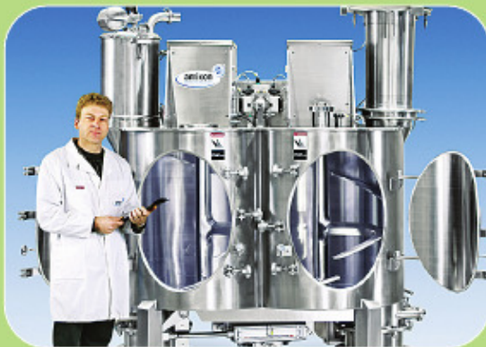
Κάθετος αναμίκτης AMIXON διπλού άξονα για συνδυασμό έντονης & ήπιας ανάμιξης.
