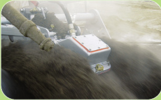
Μέτρηση υγρασίας στην τέφρα σε εγκατάσταση παραγωγής ενέργειας.
