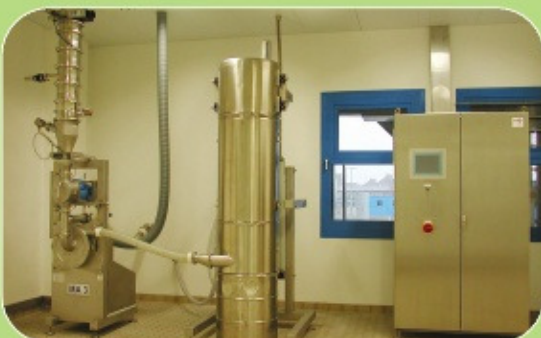
Πλήρως ανοξειδωτος μύλος άλεσης Jehmlich σε ατμόσφαιρα αζώτου (ATEX).
