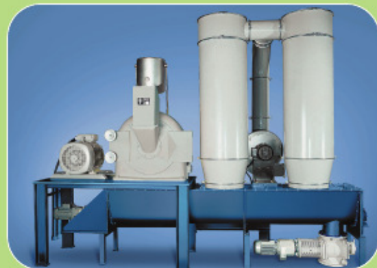
Μύλος άλεσης 600 kg/h ριζαλεύρου για παραγωγή παιδικών τροφών.
