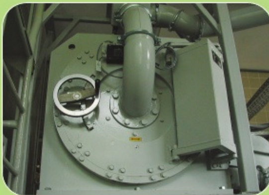
Μύλος άλεσης ζάχαρης για παραγωγή 5.000 kg/h άχνης.
